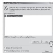
4. [停止硬件装置] 窗口会打开。选择 [USB Mass Storage Device], 然后单击 OK 按钮。
