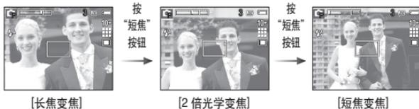
数码变焦“短焦”：使用数码变焦时，按“短焦”按钮，会逐步减少数码变焦。松开“短焦”按钮，可停止数码变焦。按“短焦”按钮会减少数码变焦，然后相机会继续减少光学变焦直至最小。
